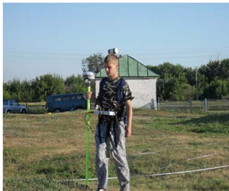
Работа с протонным магнитометром POS—1 к юго-востоку от Соборной мечети
