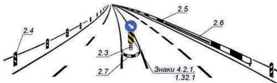
Рисунок А.22 - Обозначение объездов островков безопасности и различного рода опасностей
