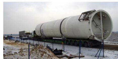
Budowa Odazotowni. Transport jednego z trzech zbiorników LNG o wysokości 26 m i pojemności 297 m 3 na plac budowy
