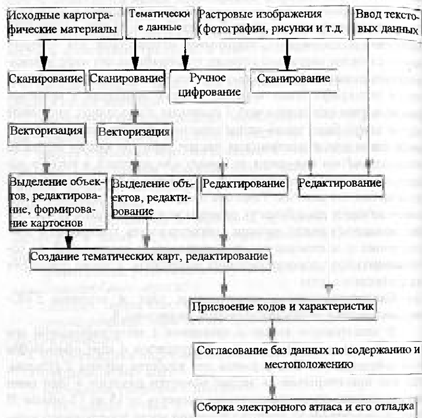
Рис. 9. Схема формирования баз данных и подготовки электронных карт для атласа
