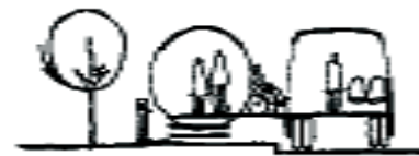
为满足库里蒂巴对大容量、现代与经济型公共交通模式的需求，杰米·勒纳首创的管筒式车站通过高月台与传统高底盘巴士的地板齐平（约 800mm），乘客不用上下踏步，即可像乘坐地铁一样水平快速登车
