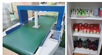
検針器の動作状況を確認
