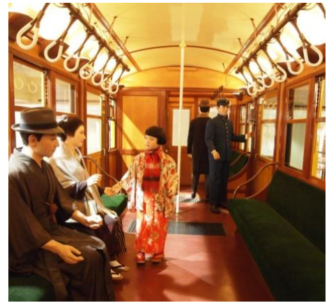
地下鉄車内（復元） 立ち客用のつり手は白いホーロー引きバネの入った「リコ式吊り手」というアメリカの新型を輸入した。（地下鉄博物館）
