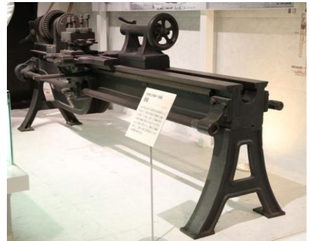
1889(明治22)年に町工場であった池貝鉄工所が製作した日本初のイギリス式旋盤 (国立科学博物館提供)
