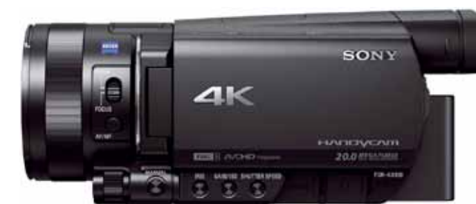
Videocamera dotata di "visione notturna" (Nightshot) all'infrarosso (modello FDR AX100). Sulla destra illuminatore aggiuntivo all'infrarosso.
