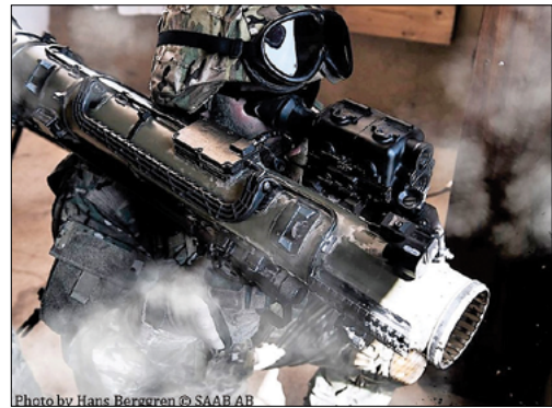
FIGURA 9: CARL GUSTAF M4, DISPARANDO DESDE UN ESPACIO CONFINADO CON SISTEMA DE MIRA INTELIGENTE
