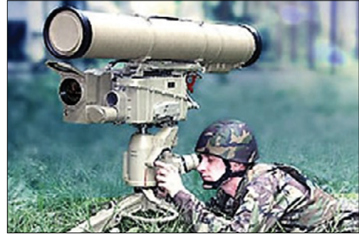
FIGURA 5: SISTEMA RUSO KORNET-ME PORTÁTIL CON GUIADO SACLOS ( SEMI-AUTOMATIC COMMAND TO LINE OF SIGHT )
