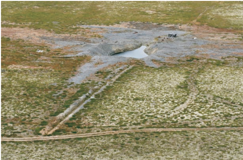
Разведочные каналы и опытно-промышленный карьер на месторождение кианита Новая Шуурурта, Большие Кейвы, фото Д. Жирова
