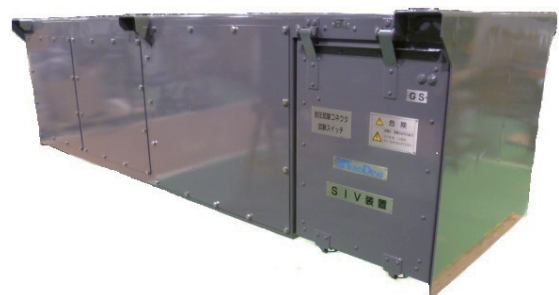
■ 図6 補助電源装置 Fig.6 Static inverter
