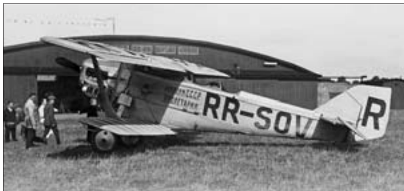
АНТ-3 (Р-3) — первый серийный металлический самолет А.Н.Туполева. В 1926 г. на этой машине был совершен демонстрационный перелет по городам Европы
