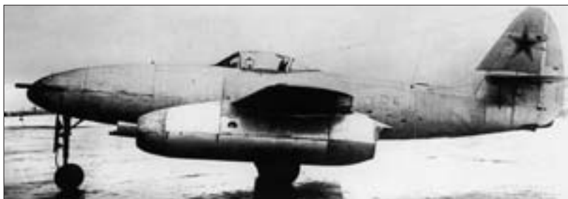
Конструкция реактивного истребителя Су-9 несли явный отпечаток немецкого Me 262
