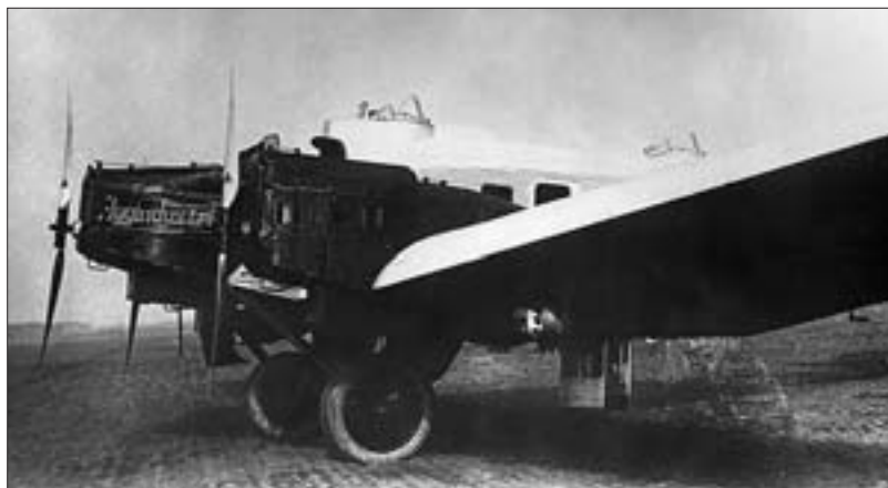
Бомбардировщик ЮГ-1. Обращает на себя внимание выдвинутая вниз пулеметная башня
