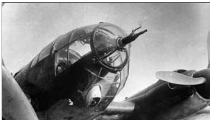
Носовая часть бомбардировщика He 111H-11 из группы II/KG53. Хорошо видна установка полуподвижной пушки MG-FF в остекленном носу фюзеляжа
