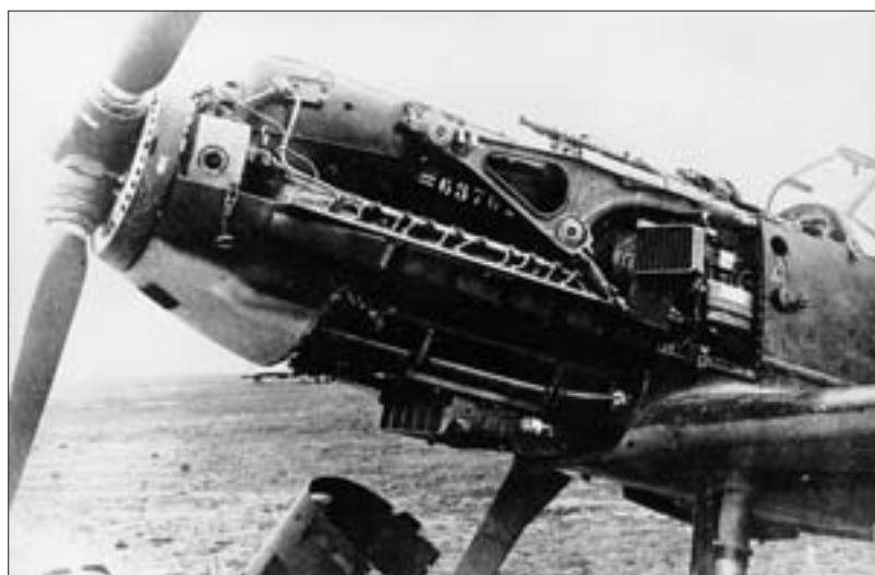
Раскапченный мотор трофейного Vf 109E. Хорошо видны агрегаты винтомоторной группы
