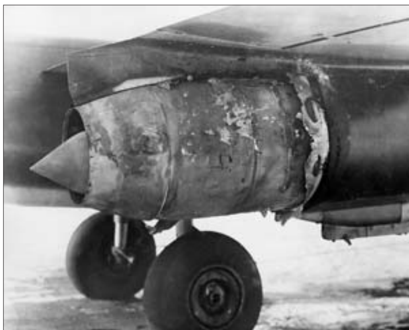
«Арадо», приземлившийся после возгорания реактивного двигателя
