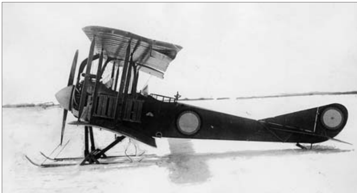
«Лебедь–ХII» с измененным капотированием двигателя и вынесенным за верхнее крыло выхлопным патрубком
