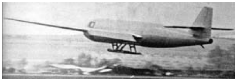
Прототип сверхзвукового «Зибель-346» — высотный ракетоплан DFS 228. Он испытывался в Германии в конце войны
