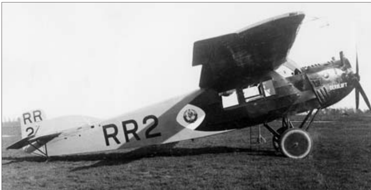
С 1925 г. на линии появились усовершенствованные «Фоккеры» с измененным капотом двигателя, увеличенным килем и закрытой кабиной экипажа
