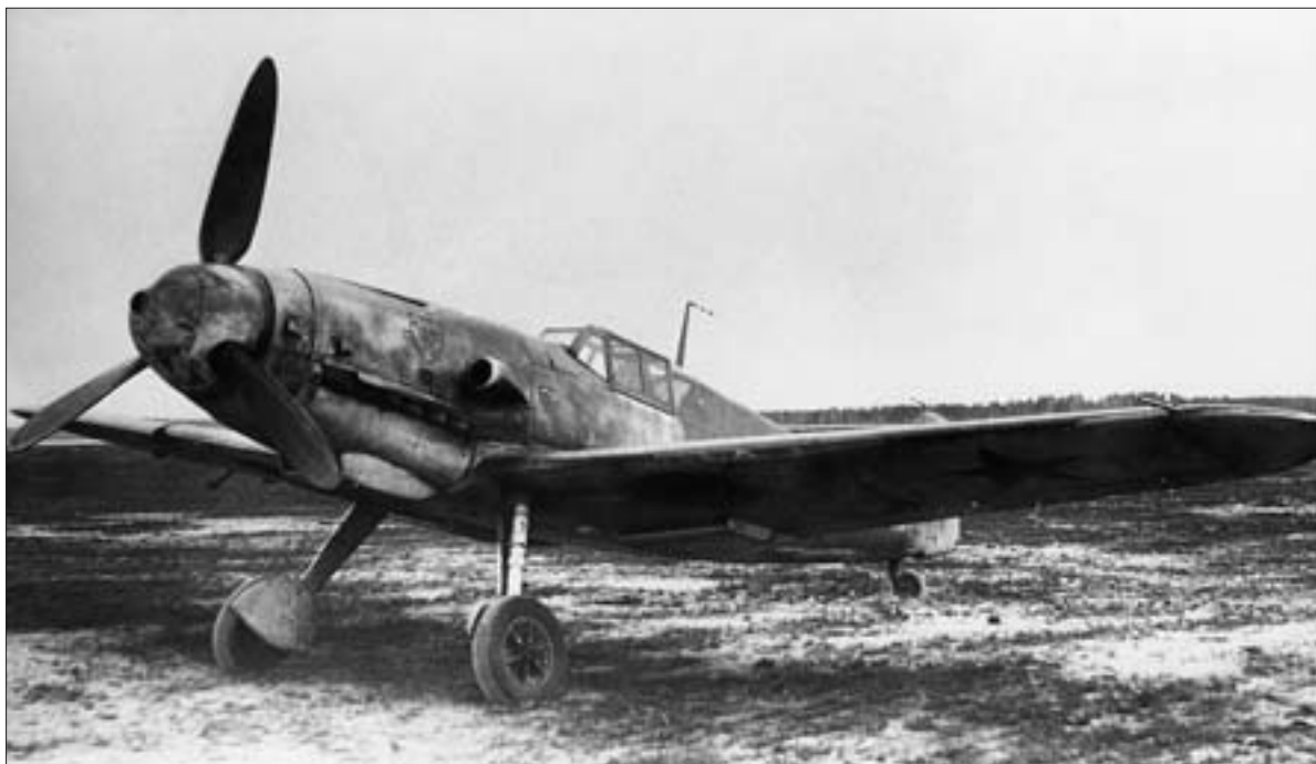
Bf 109G-2 № 14513 из группы II/JG3 «Удет» отремонтирован и приведен в летное состояние после воздушного боя 19 марта 1943 г. Он прошел испытания в НИИ ВВС как «трехточечный» «мессершмитт»
