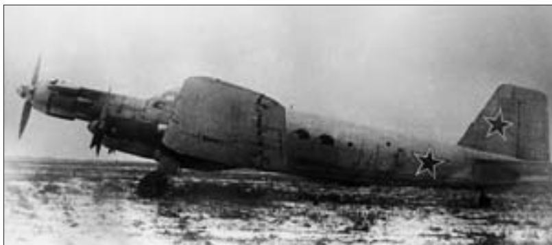
«Летающая лаборатория» на основе Ju 52 использовалась в НИИ ВВС для испытания в полете различных двигателей
