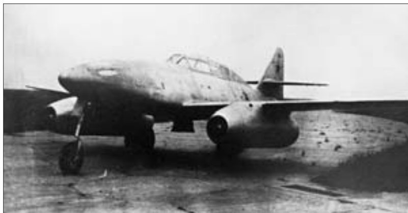
Двухместный Me 262В–2 проходил специальные летные испытания в НИИ ВВС в варианте учебного истребителя без использования бортовой локационной установки. Сентябрь 1946 г.
