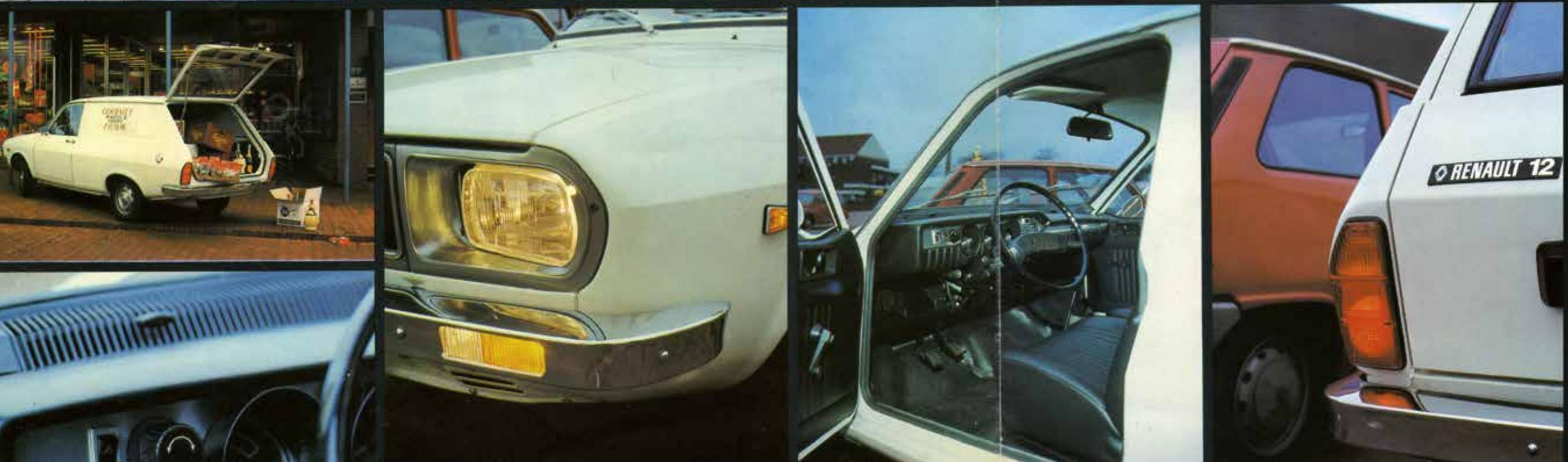
RENAULT 12 Van har en laståbning på 129 cm bredde og 76 cm højde. Forlygterne er indstillelige fra en betjeningsknap på instrumentpanelet, således at lyslængden altid kan korrigeres efter vognens belastning. De store, moderne lygter og den luksuriøse førerkabine, identisk med RENAULT 12 personvogn, er med til at gøre denne store varevogn til et af markedets bedste tilbud.
