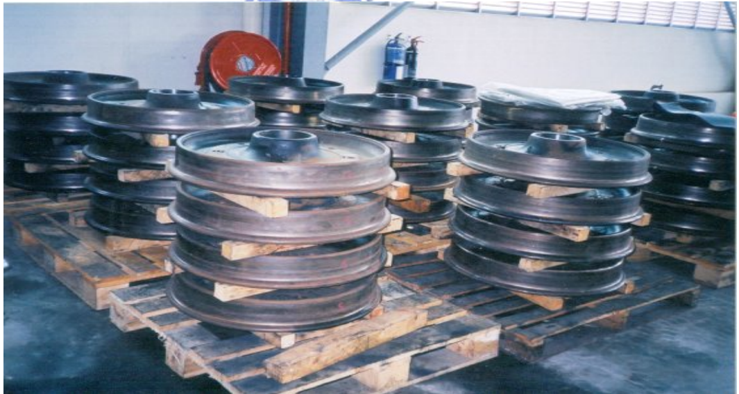
圖 2.9 機場快線倉儲儲存大型車輪情形
