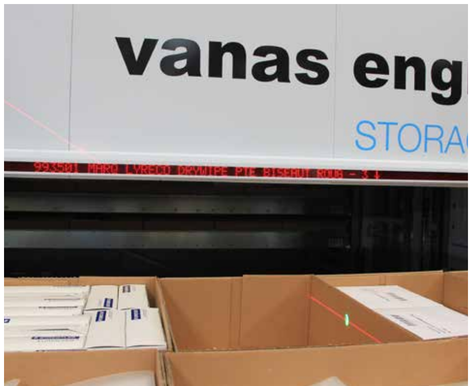
Op basis van een laser en een led-bar – waarop de naam van het artikel, het aantal te picken stuks én een pijltje naar de juiste locatie verschijnen – weet de medewerker exact wat hij moet verzamelen.
