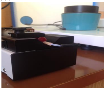
Obr. 1. Detail kapiláry s funkčným nanorozmerným povrchom napojenej na mikrofluidnú pumpu
