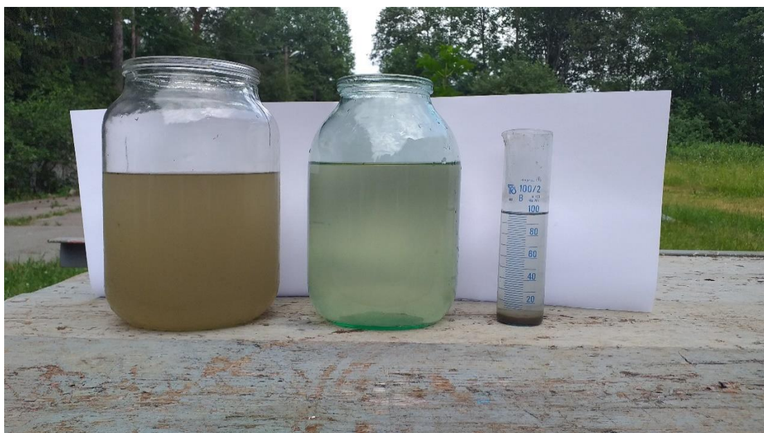
Рисунок 3.2 – Пробы воды, отобранные на станции водоочистки. Слева – неочищенная вода, в центре – вода после очистки, справа – проба на активный ил (фото автора)
