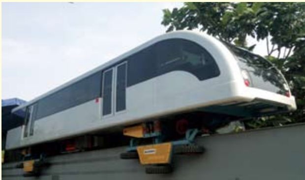
Tampak dari samping Prototype Monorail keadaan Bogie terbuka (Skirt belum dipasang)
