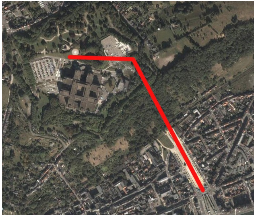
Illustration 4: Tracé d'un possible téléphérique entre l'esplanade St Léonard la et la Citadelle. La gare des bus, actuellement située à droite de l'entrée de l'hôpital, devrait être déplacée sur la gauche pour permettre la correspondance entre ces deux moyens de transports.
