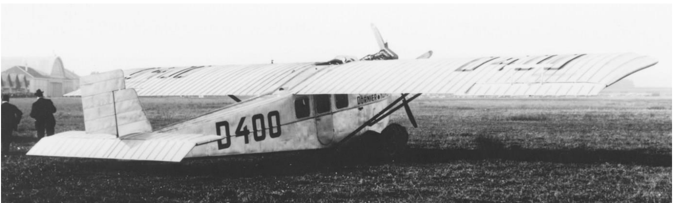
Die „Komet II“, Werknummer 53, wurde Mitte 1924 kurzzeitig als D-400 für DMB zugelassen. Im Winter 1924/25 erfolgte der Umbau in ein Luftbild-Flugzeug einschließlich Austausch des Rolls-Royce „Falcon III“-Motors gegen einen BMW IVa (250/300 PS). Im März 1925 ging die Maschine an die russische Fluggesellschaft DOBROLJOT und erhielt dort das Kennzeichen RR-DBB.
