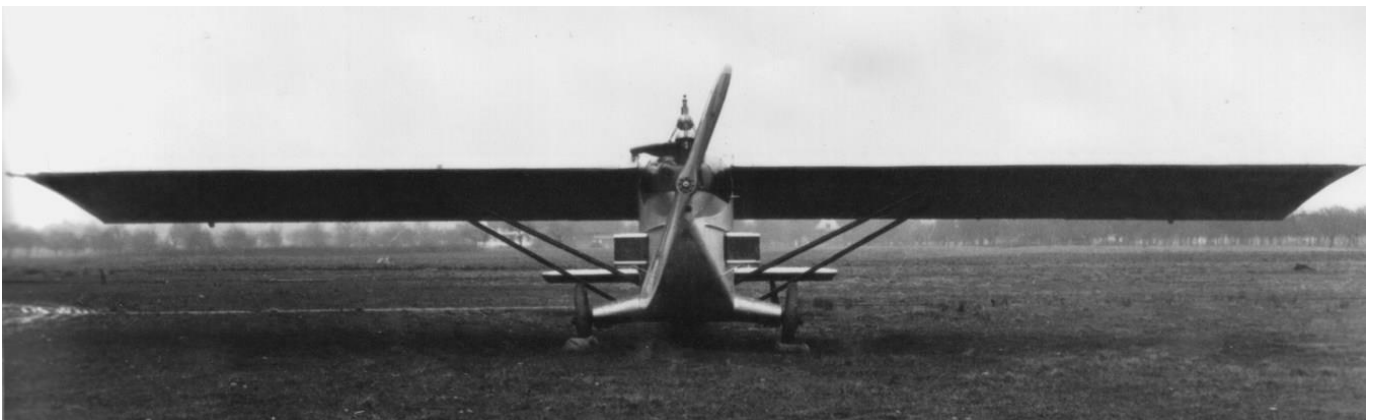
So sahen die Dornier „Komet II“ Luftbild-Flugzeuge nach Umrüstung auf das BMW IVa-Triebwerk aus. Den großen Stirnkühler hatte man durch seitliche Kühler am Bug ersetzt (im Fliegerjargon auch als „Ohrenkühler“ bezeichnet). In dieser Form wurden die Werknummern 51 und 53 als Luftbild-Flugzeuge nach Rußland an die DOBROLJOT verkauft. (Historisches Unternehmensarchiv Dornier, Immenstaad)
