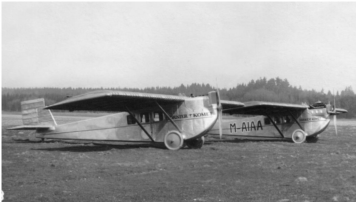
Auf dem Flugplatz Friedrichshafen-Löwental präsentieren sich im Herbst 1922 die beiden Versionen des Dornier-Verkehrsflugzeugs „Komet“: links eine „Komet I“ mit Sechszylinder-Reihenmotor BMW IIIa, rechts das Musterflugzeug „Komet II“ mit dem Zwölfzylinder V-Motor Rolls-Royce „Falcon III“, auslieferfertig nach Spanien. (Archiv Zeppelin-Museum Friedrichshafen)
