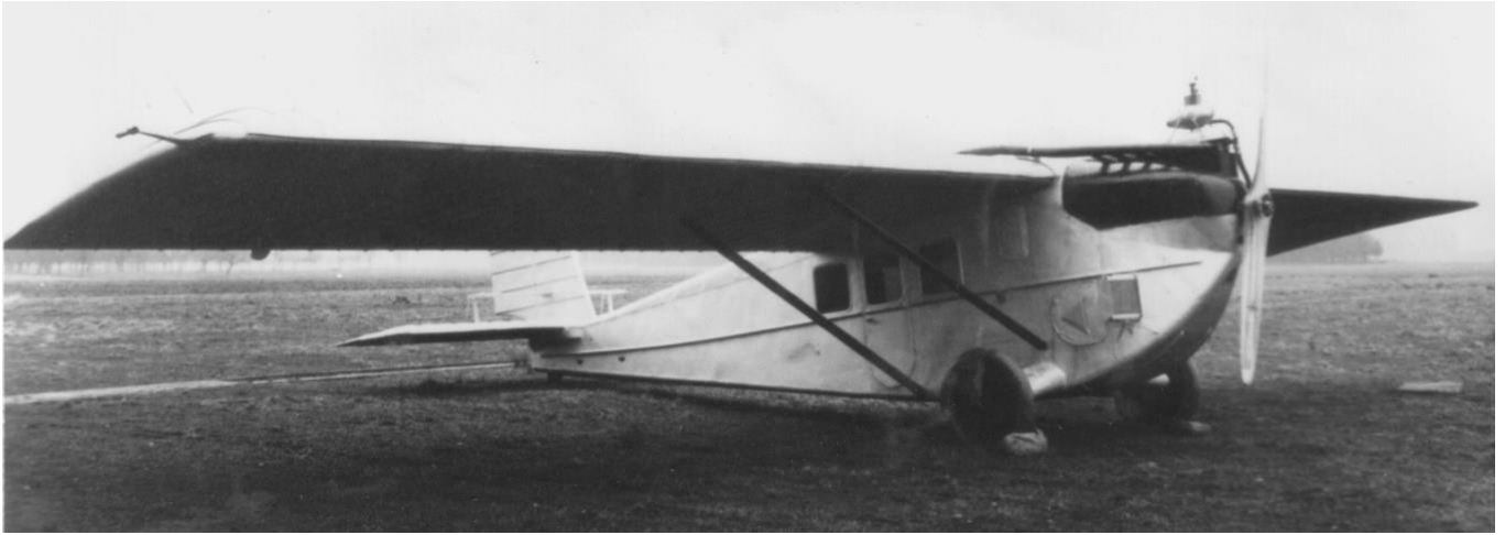
So sahen die Dornier „Komet II“ Luftbild-Flugzeuge nach Umrüstung auf das BMW IVa-Triebwerk aus. Den großen Stirnkühler hatte man durch seitliche Kühler am Bug ersetzt (im Fliegerjargon auch als „Ohrenkühler“ bezeichnet). In dieser Form wurden die Werknummern 51 und 53 als Luftbild-Flugzeuge nach Rußland an die DOBROLJOT verkauft. (Historisches Unternehmensarchiv Dornier, Immenstaad)
