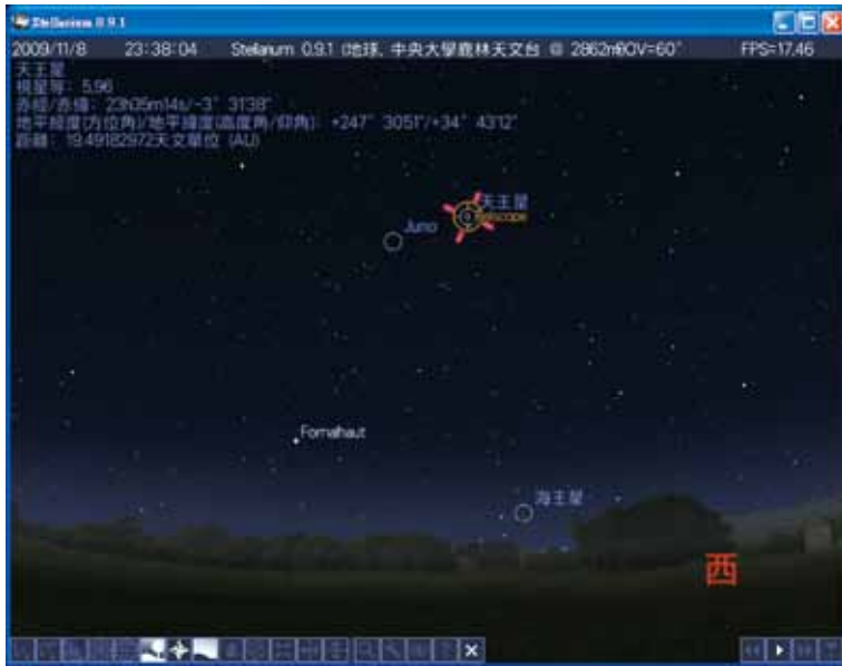
圖：Stellarium與赤道儀連線時，除了原有的白色準心之外，還會有一個橘色的準心代表望遠鏡的指向。工具列按鈕，因為設定flag_show_flip_buttons=true而多出兩個變更鏡射畫面的按鈕。
