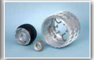
左圖為火星三代探測車之實體比較，最小的就是第一代的火星探路者號—Sojourner，中等大小的第二代就是目前尚在火星上執行任務的機會號及精神號，最大的第三代就是即將在2011年秋天出發的火星任務--火星科學實驗室中的Curiosity。右圖為三代探測車之輪子大小比較。
