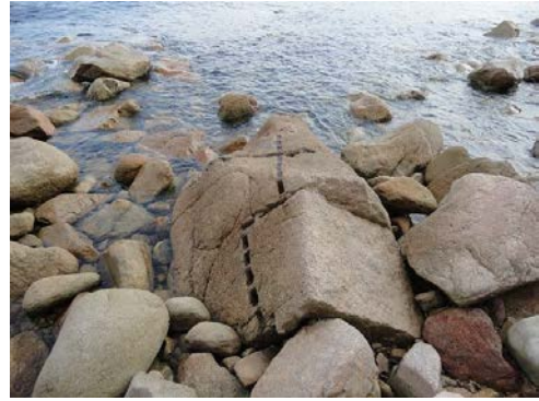
【写真2】指月山々裾東海岸（北矢倉跡周辺）に残る矢穴を残す石材
