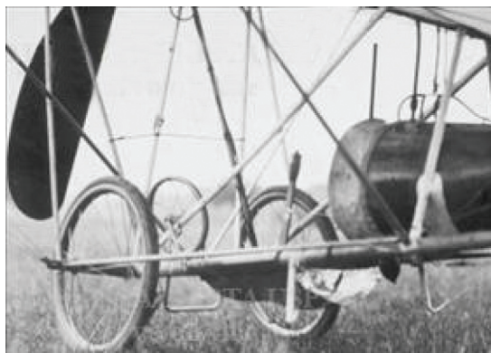
Detalhes do assento e trem de pouso da aeronave Demoiselle 65
