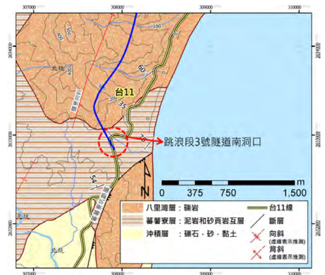
圖八 跳浪段邊坡附近地形與地質概況
