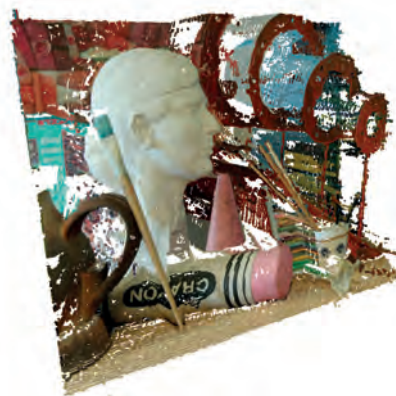
Abbildung: Referenz-Eingabebild des Plane Sweep Stereo sowie entstehendes 3D-Modell im Rohformat, ohne weitere Bearbeitung.
