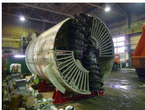
Рис.3 - Собранный прототип геохода
