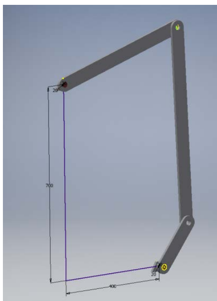
Рис.4 - Построенный план механизма при заданной обобщенной координате \varphi
