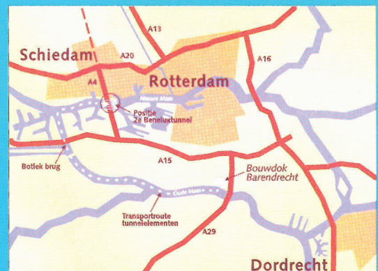
Ligging van het bouwdok en transportroute tunnelementen van de 2 e Beneluxtunnel.
