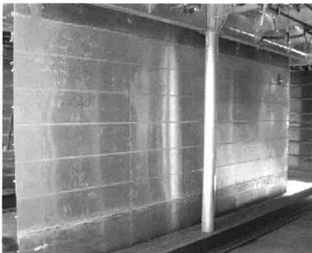
図9 FSW接合パネル製隔壁 (三井造船 (株) 提供)
