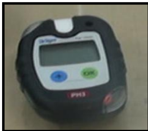
Gambar 30. Alat pendeteksi kebocoran
