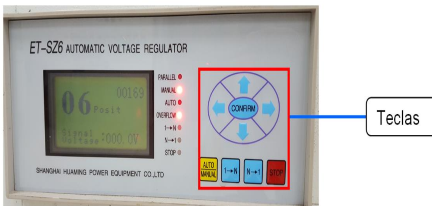
Figura 2.7. Regulador de tensión AVR ET-SZ.
