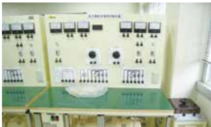
▲直流電動発電機実験設備
