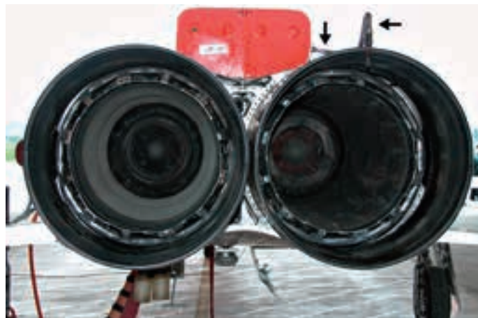
Das Rauchöl wird über ein Röhrchen direkt in den Abgasstrahl des rechten Triebwerks General Electric J85-GE-21A eingespritzt (siehe Pfeil).
