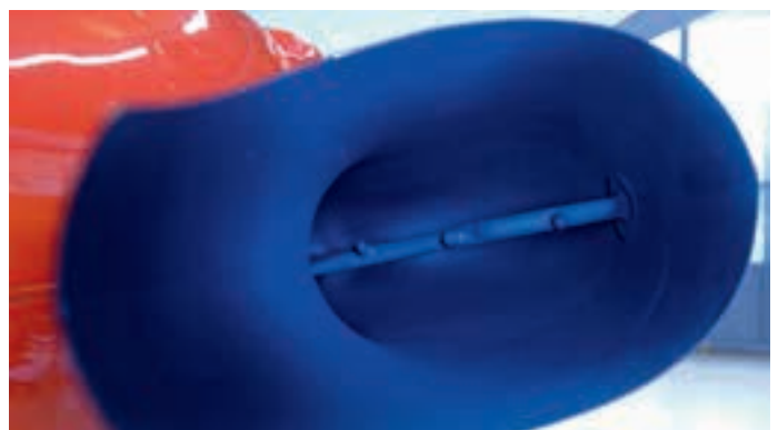
Das Öl-Diesel-Gemisch wird direkt in den rechten Auspuff des Pilatus PC-7 eingespritzt.
