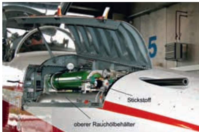
Die beiden je 40 Liter fassenden übereinanderliegenden Ölbehälter (grau) und die Stickstoffflasche (grün) sind anstelle der rechten Bordkanone eingebaut. Diese Modifikation ist bei geschlossener Abdeckung nicht sichtbar.
