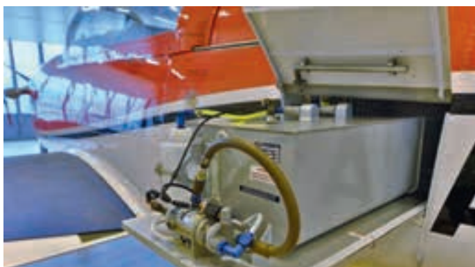
Die im Gepäckfach eingebaute Rauchanlage kann jederzeit im Handumdrehen ausgebaut werden, wodurch die PC-7 wieder uneingeschränkt für den Schulungsbetrieb zur Verfügung stehen.
