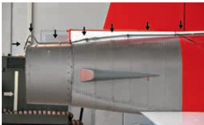
Das Öl wird durch eine an der Aussenhaut angebrachte Leitung zum Triebwerksauslass geführt. Nur zehn der zwölf rotweissen F-5E Tiger II sind mit dieser Ölleitung ausgerüstet.
