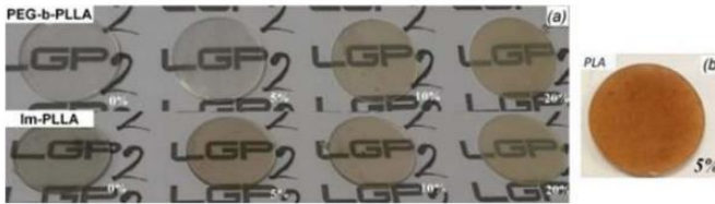
Gambar 7 Pengaruh penambahan berbagai tingkat surfaktan yang dimodifikasi ke PLA dan injeksi yang dicetak ke dalam cakram Sebuah dan gambar komposit PLA yang tidak dimodifikasi (Mariano et al. 2017). Direproduksi dengan izin dari American Chemical Society melalui penerbitan akses terbuka
