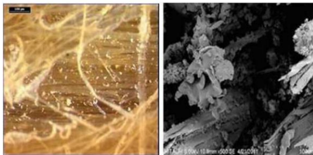
Gambar 5 Resin basah yang buruk (Suriani et al. 2012)
