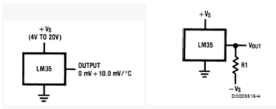
Gambar 4.2. Rangkaian Dasar LM35
