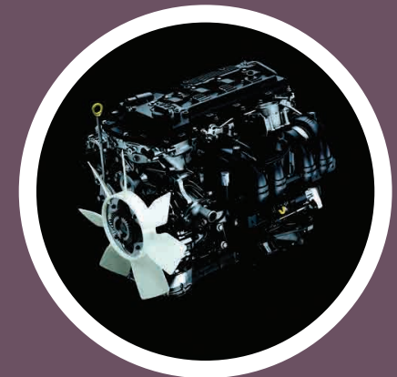
Motor 2.7 litros con Dual VVT-i.
