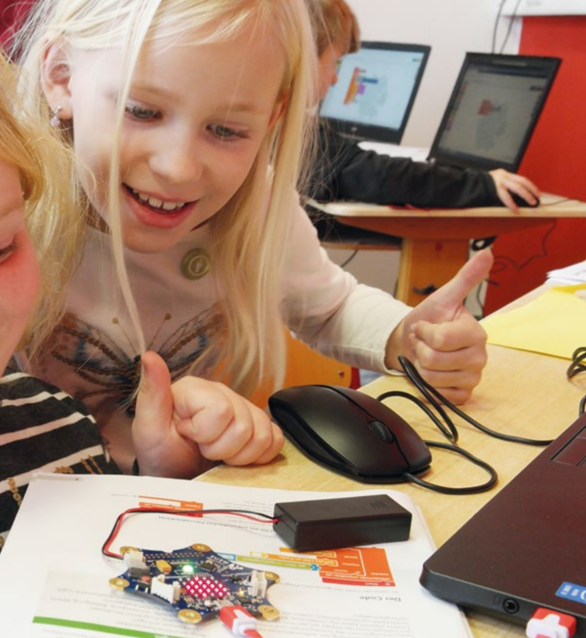
Grafik unten: Exemplarisch sei hier eine Einstiegsübung gezeigt, die mit nur 2 Zeilen „Code“ auskommt: Drückt man am Calliope die Taste A, erscheint auf dem LED-Feld die Laufschrift: Hallo Welt.
