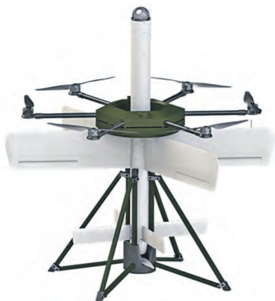
Барражирующий боеприпас ST-35 запускается вертикально вверх с использованием гексакоптера
