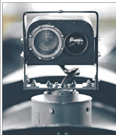
Украинский безэкипажный надводный аппарат «Мыкола-3» (на рис. справа – оптико-электронная станция)
