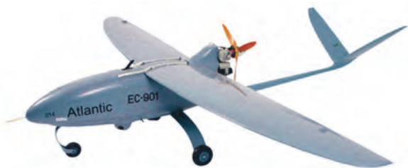
Многоцелевой беспилотный летательный аппарат «Атлантик-1». Автономность полета около 5 ч при крейсерской скорости 110 км/ч (масса незагруженного 38 кг)
