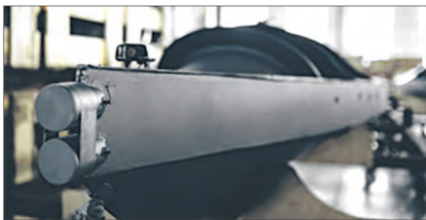
Контактные взрыватели в носовой части БНА
