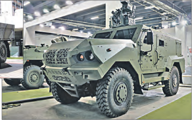
Многоцелевой броневедомитель, созданный на базе грузовика «Татра» Т815 (слева), с дистанционно управляемым модулем вооружения ZSMU A5 (справа)
