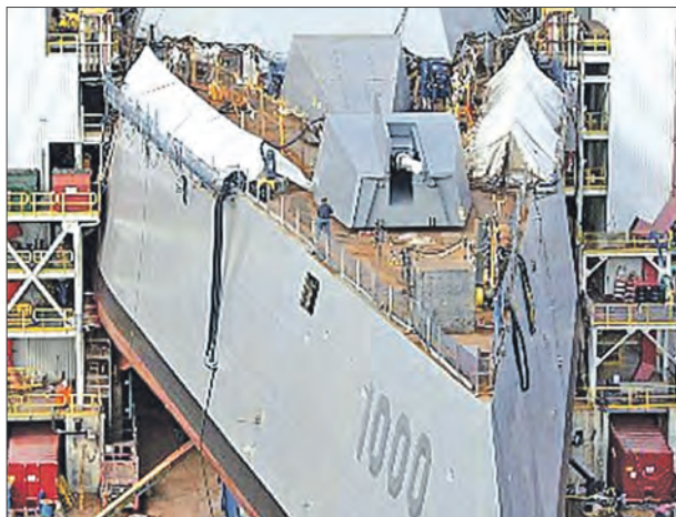
Размещение артустановки «Агс» на борту эсминца УРО типа «Зумвольт»
