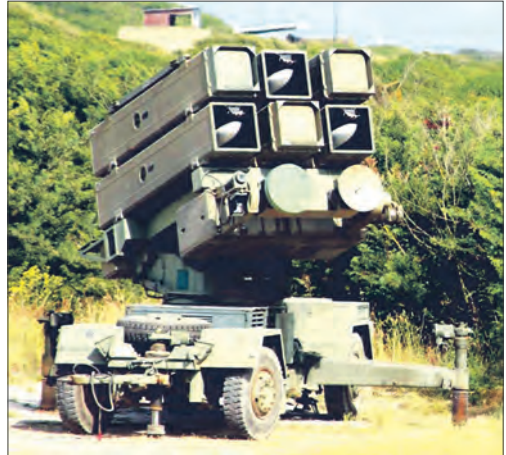
Буксируемая пусковая установка ЗУР из состава ЗРК «Скайгард-Аспид»
