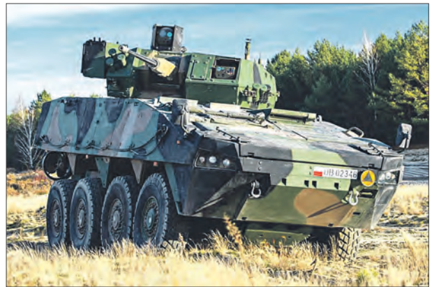
Боевая машина «Росомак» с дистанционно управляемым модулем вооружения ZSSW-30
