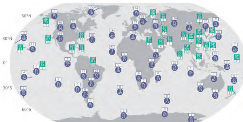
Схема расположения стартовых площадок (зеленый цвет – число проведенных пусков) и инфразвуковых станций МСМ (синий – количество зарегистрированных пусков РН)
