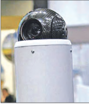
Опτικο-электронный блок наведения на цель соединен с боевой частью барражирующего боеприпаса
