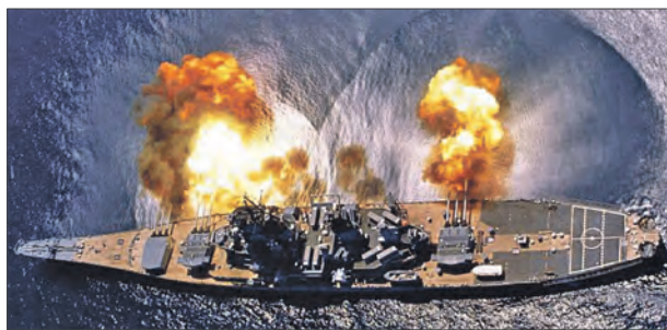
Залп артиллерии главного калибра линейного корабля «Айова» (одна кормовая башня заменена пусковыми установками крылатых ракет морского базирования «Томахок»)
