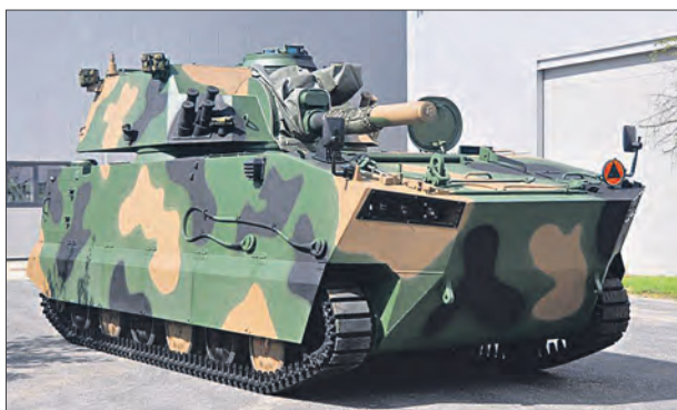
Опытный образец 120-мм самоходного миномета M120G «Рак» на гусеничном ходу
