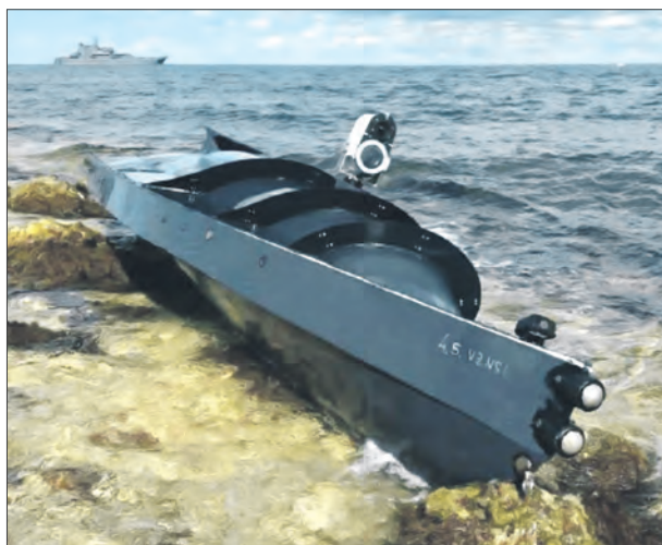
Украинский безэкипажный надводный аппарат «Мыкола-3» (на рис. справа – оптико-электронная станция)
