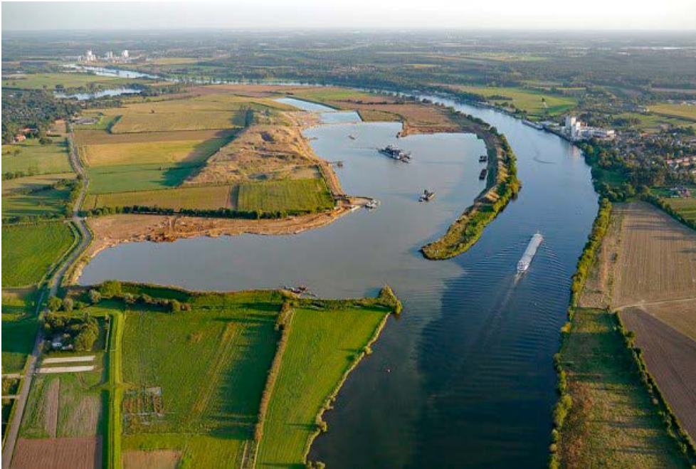
Afb. 9.6 De ontgrondingen met winning van grind en zand in het kader van de aanleg van de Hoogwatergeul te Well-Aijen in volle gang, na voltooiing van de archeologische onderzoeken (najaar 2016, gezien naar het zuiden toe; bron: Beeldbank Maaspark Well, Aeropicture Luchtfotografie).
