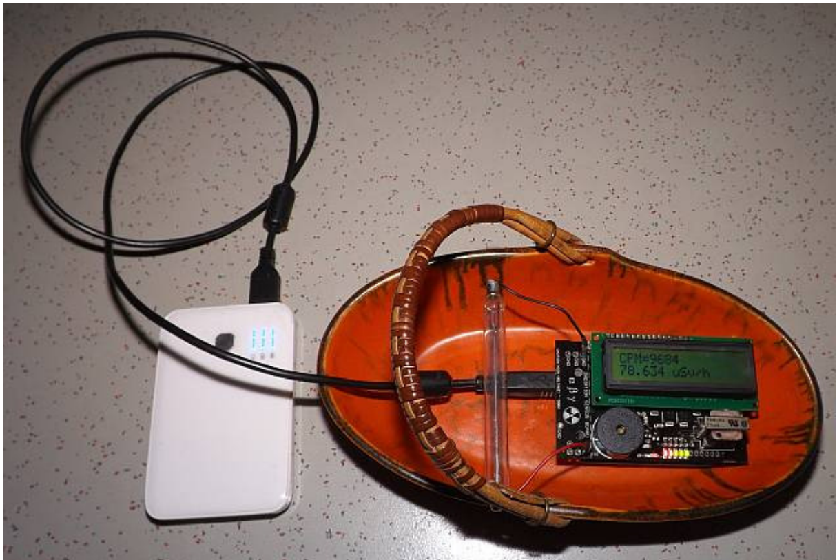
Abb. 3: Messung einer hohen Zählrate in einer Keramikchale mit Uranglasur
