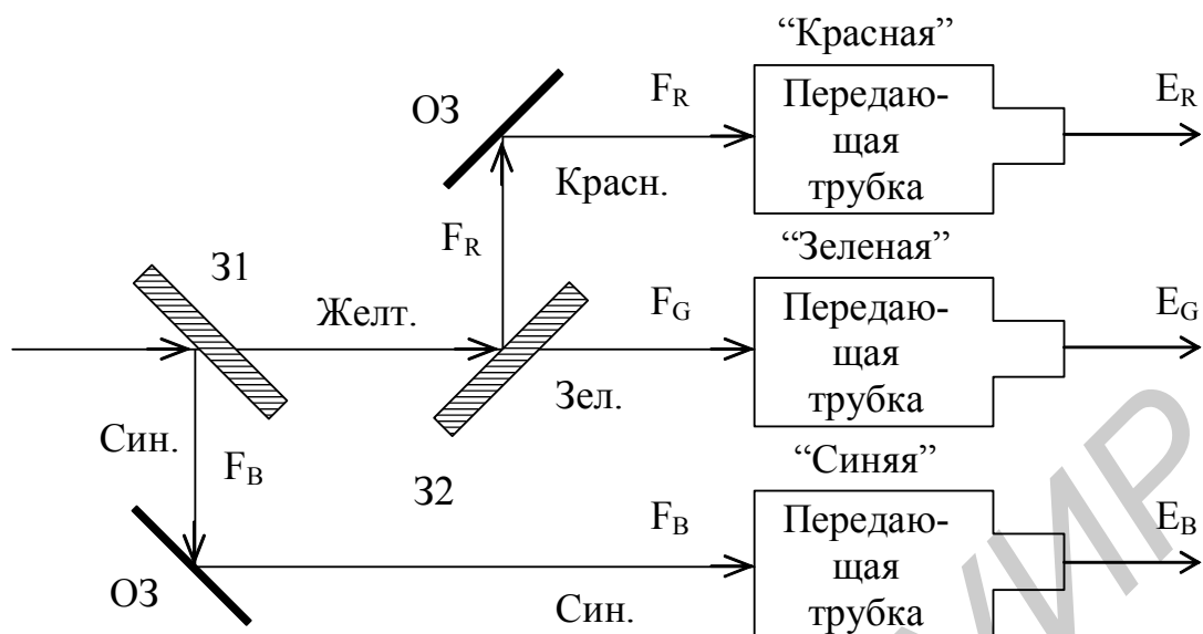
Рис. 7.2. Структурная схема трехтрубчатой передающей камеры цветного изображения
