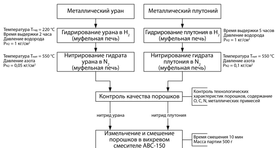
Рис. 14.2. Технологическая схема получения смеси нитридов урана и плутония из индивидуальных металлов
