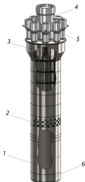
Рис. 24.6. Схема парогенератора: 1 – теплообменные трубки; 2 – вход теплоносителя; 3 – крепежный фланец; 4 – камеры питательной воды; 5 – паровая камера; 6 – обечайка
