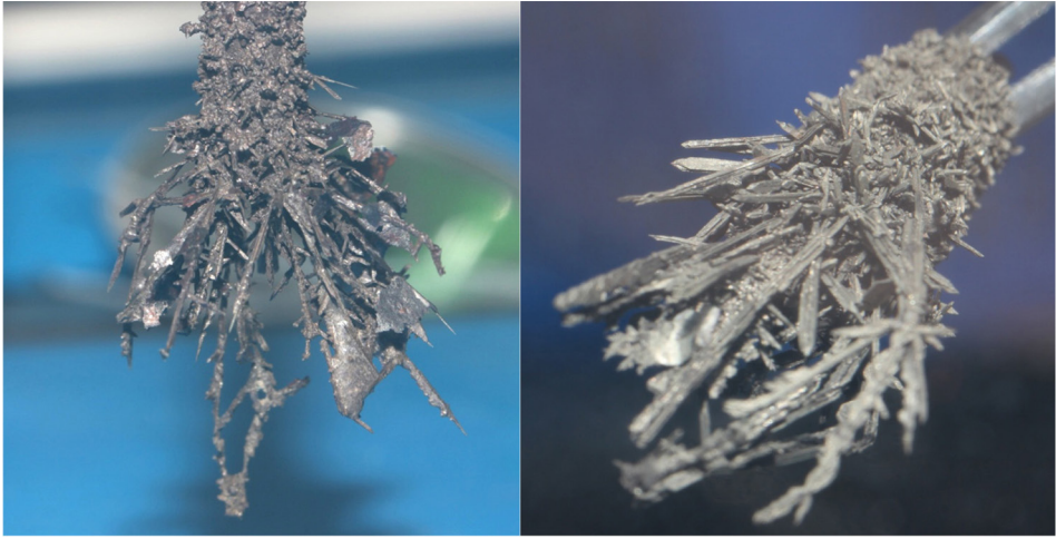
Рис. 20.5. Фотографии катодного осадка до (слева) и после (справа) очистки от хлоридного электролита методом отгонки
