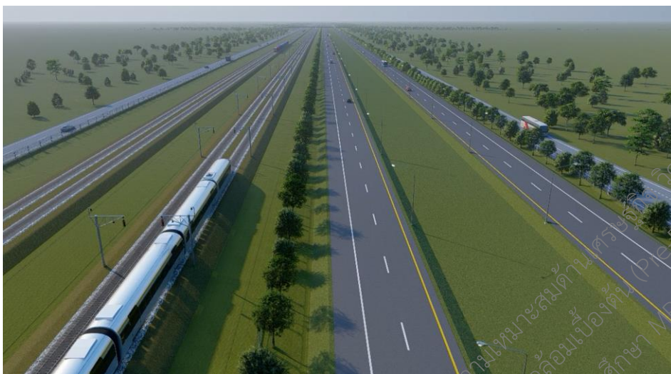
รูปที่ 6-3 แนวคิดการออกแบบ การใช้พื้นที่เขตทางกรณีพัฒนาทางหลวงพิเศษระหว่างเมือง ร่วมกับทางรถไฟและรถไฟความเร็วสูง
