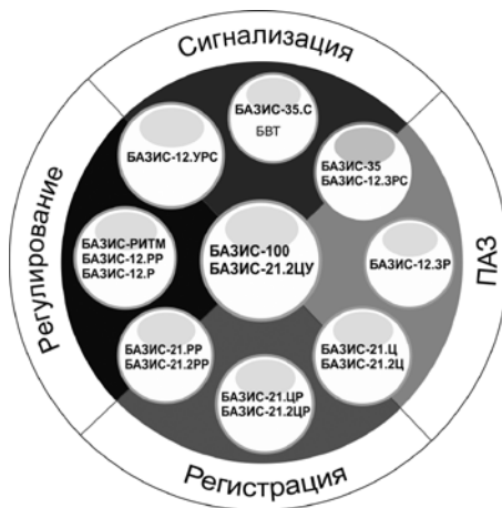
Рис. 1. Группировка контроллеров серии БАЗИС по функциональным областям
