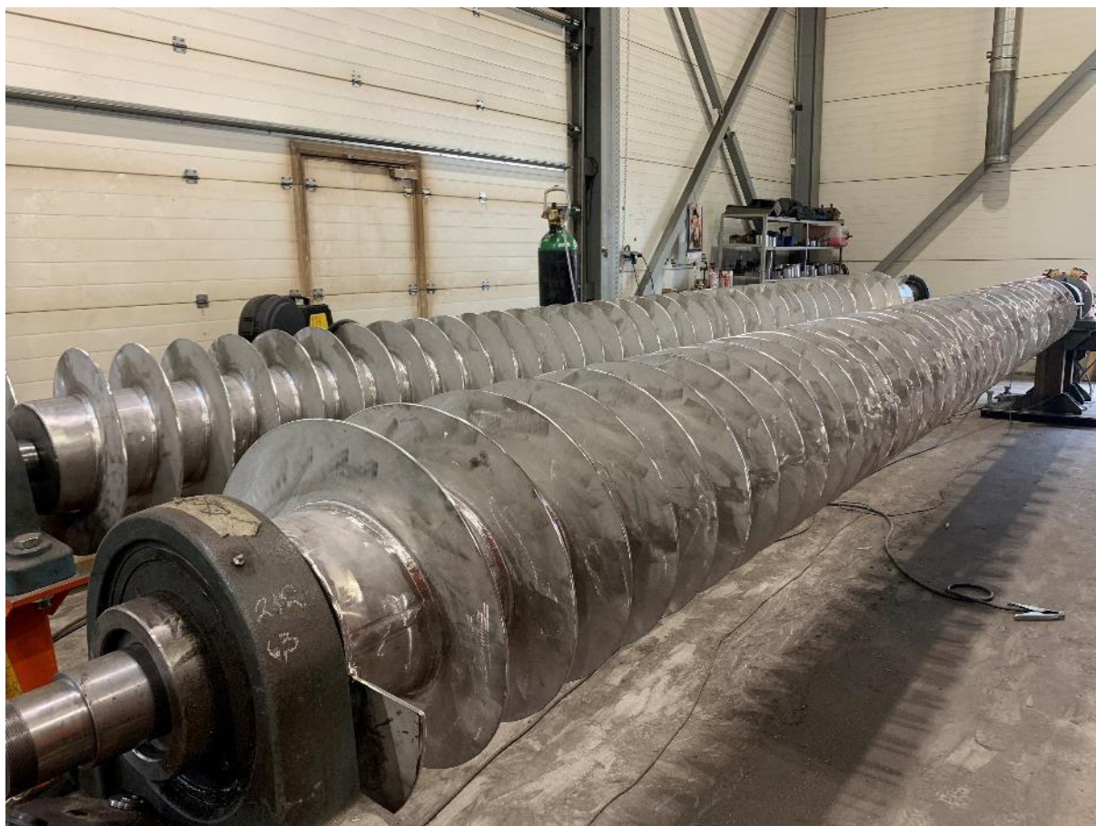
Joonis 4.27. Tigukonveieri valmistamine masinaehituse ettevõttes AS Welmet Halinga ettevõtlusalal (Foto: Hendrikson ja Ko)
