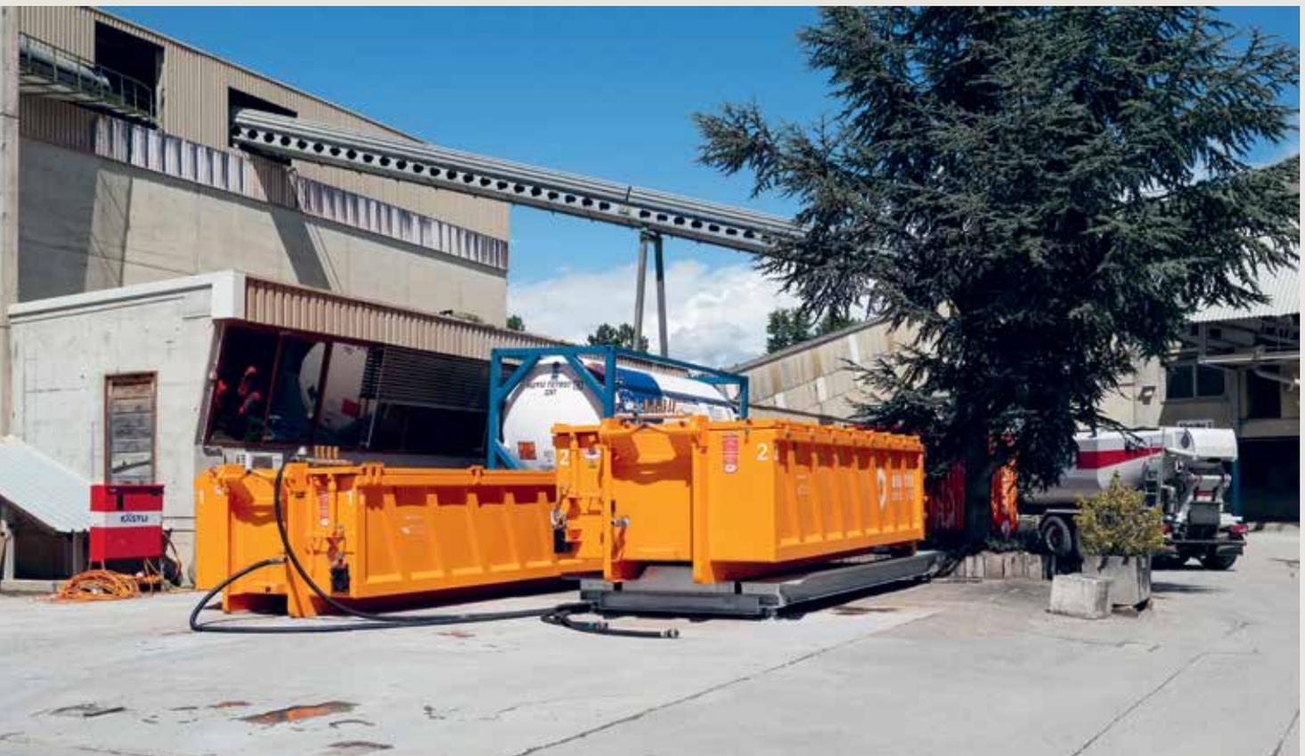
Die Firma neustark verwendet zur Herstellung von Beton statt Kies ein Granulat aus Abbruchbeton, das mit CO<sub>2</sub> angereichert wurde.
