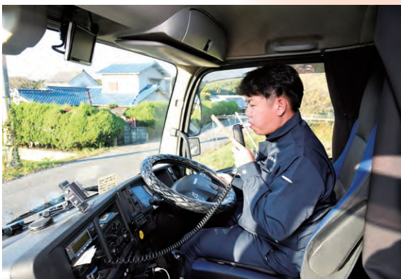
飲酒運転を防止するための呼気吹き込み式アルコールインターロック装置
