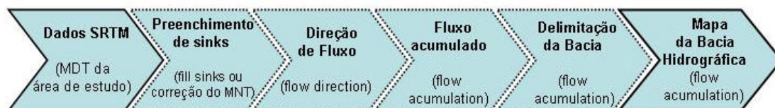
Figura 14: Principais etapas realizadas para delimitação de bacias hidrográficas a partir de dados SRTM.
