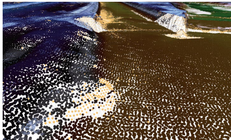
Schließen der Lücken (orange Punkte) mit einem temporären, triangulierten Netz der Randpunkte.
