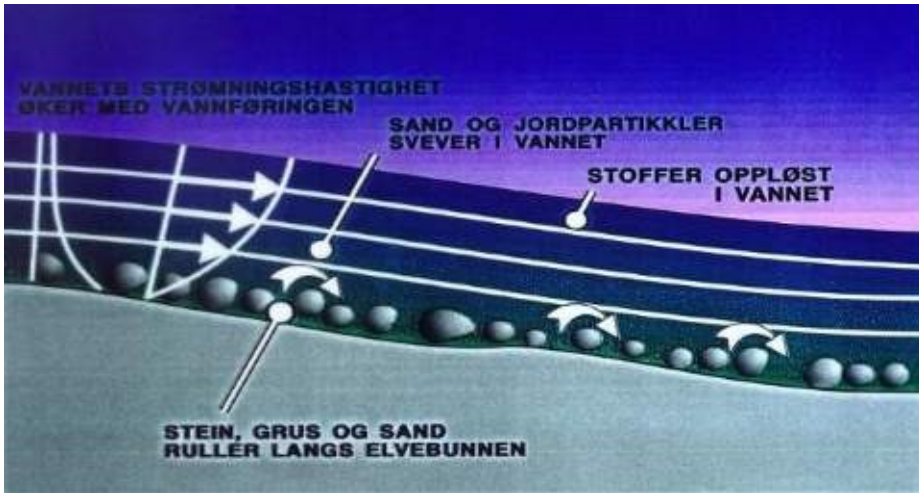
Figur 5.5: Materialtransport i vann skjer i tre ulike former: Som bunntransport langs elvebunnen; som partikler svevende i vannet (suspensjon); og som oppløst stoff. Kilde: NVE
