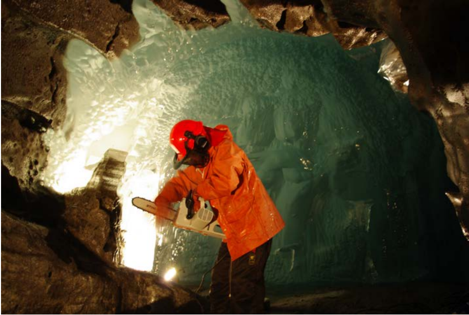
Figur 4.16: Isprøver skjæres ut fra undersiden av breen. Tilkkomsten til brelaboratoriet og undersiden av breen er gjennom tunnel i fjellet.
