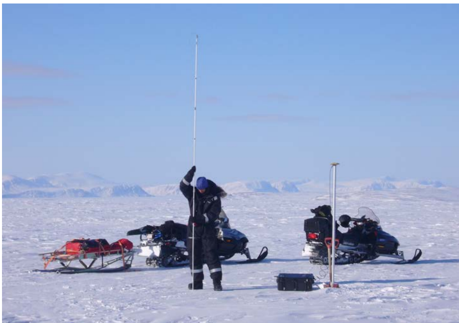
Figur 4.11: Fra feltarbeid på Austfonna. Snøsondering og GPS posisjonering. Foto: Jon Ove Hagen
