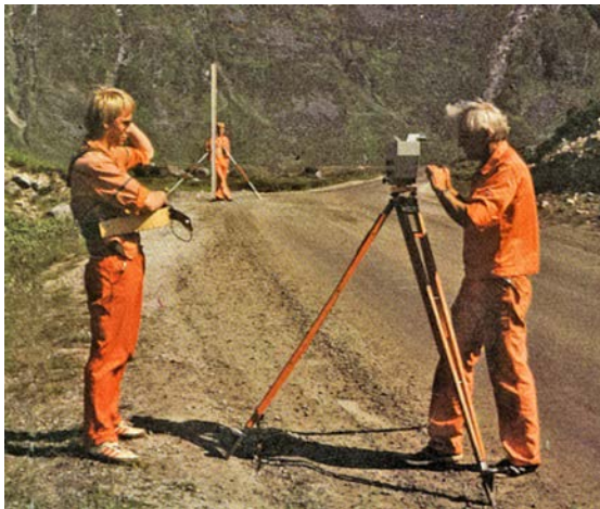
Figur 2.25: Vanlig fotnivelement med måler og to av de tre assistentene. Foto: Bjørn Geirr Harsson
