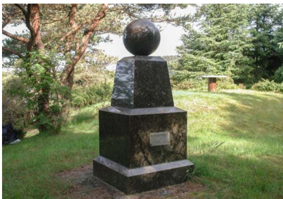
Figur 2.20: Støtten som viser utgangspunktet for det nasjonale høydesystemet NN1954. Foto: Bjørn Geirr Harsson
