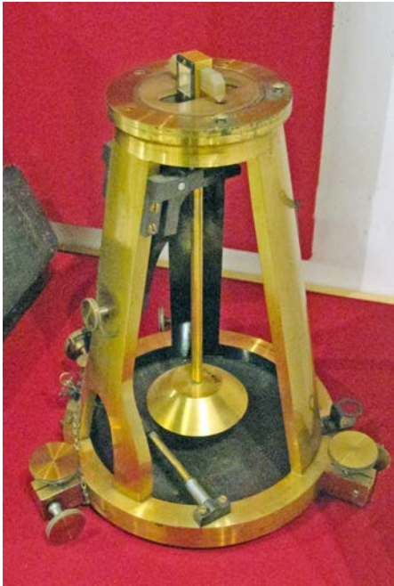
Figur 2.8: Sterneck-pendel for tyngdemåling. Foto: Bjørn Geirr Harsson
