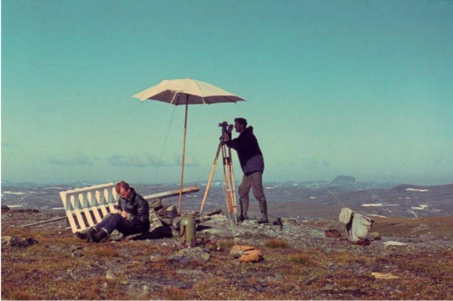
Figur 2.12: Tradisjonell måling med teodolitt. Det brukes parasoll mot solstråling. Observatøren har assistent til å notere avleste tall. Hardangervidda 1964. Hårteigen i bakgrunnen. Foto: Bjørn Geirr Harsson
