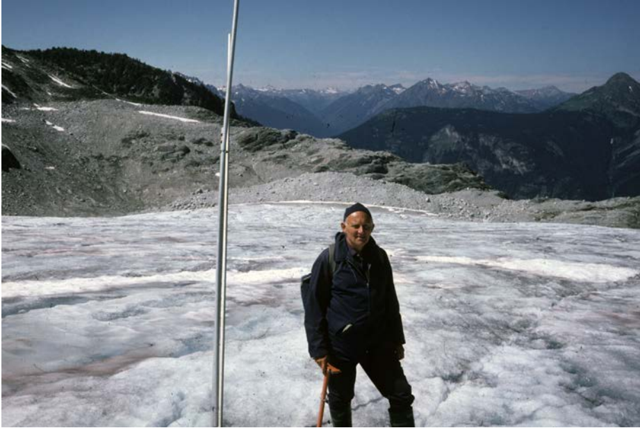
Figur 4.6: Gunnar Østrem ved siden av stake for massebalansemålinger. Å måle endringer i snø- og ismengde i forhold til staker som står fast ned i isen er teknologi som fortsatt brukes, selv om vi i dag også får annen informasjon fra bl.a. satellitter. Foto: NVE
