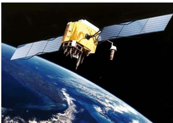
Figur 2.16: En GPS-satellitt. «Vingen» er solceller for energi. Den er stipulert å vare i ca. 7 år. Figur: NASA
