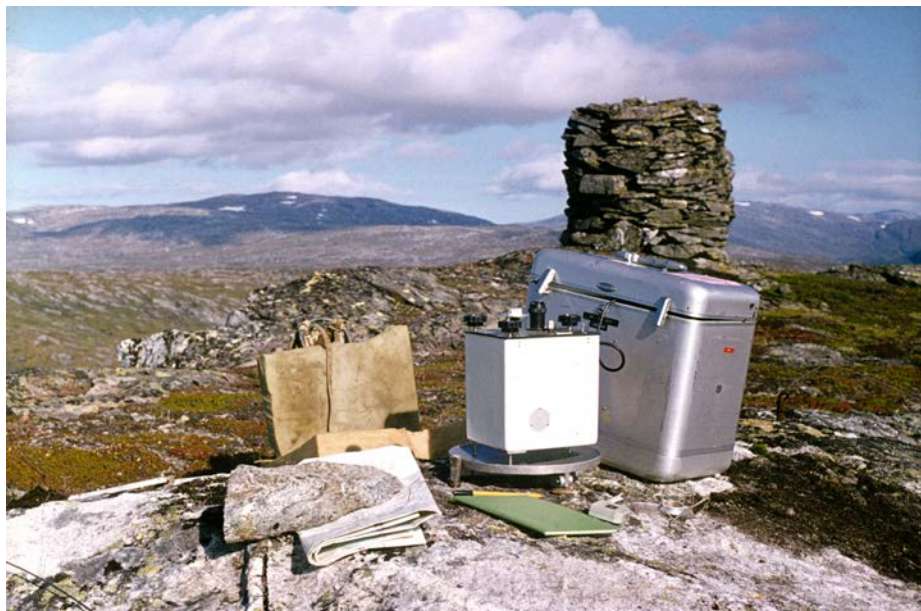
Figur 2.28: LaCoste & Romberg gravimeter med tilbehør ved et målepunkt. Foto: Bjørn Geirr Harsson
