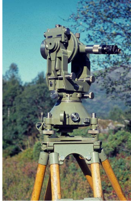
Figur 2.9: Teodolitt av typen Wild T 3 . Den var i bruk i NGO fra ca. 1920 til ca.1990. Foto: Bjørn Geirr Harsson
