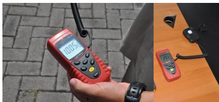
Gambar 3. Pengukuran kekuatan cahaya di luar dan dalam bangunan
