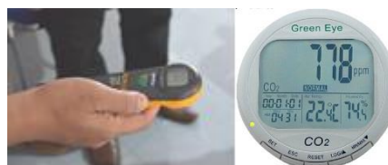
Gambar 6. Pengukuran kadar CO 2 dan contoh alat sensor CO 2
